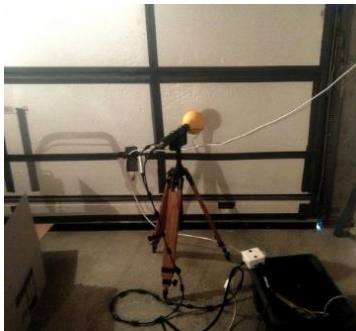
Figure 24 : emplacement des mesures de courant électrique et exemple de spectre de trames CPL Linky G3 observée (mesure de champ magnétique à 20 cm du câble)
