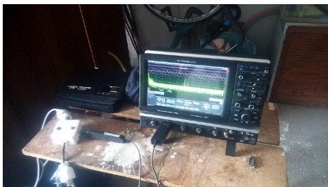
Figure 23 : emplacement des mesures de courant électrique et exemple de trames CPL Linky G3 observée (mesure de champ magnétique à 20 cm du câble)
